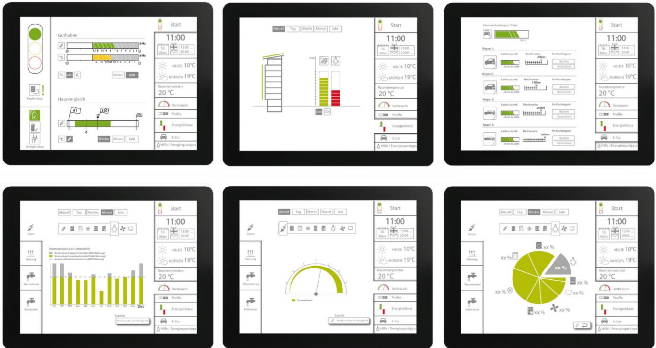
Abb. 4 Beispielseiten Nutzerinterface: Startseite, Energiebilanz, E-Mobilität, Stromverbrauch (Monat, aktuell und Vergleich der einzelnen Stromverbräuche) ; Quelle: FG Entwerfen und Energieeffizientes Bauen, TU Darmstadt
